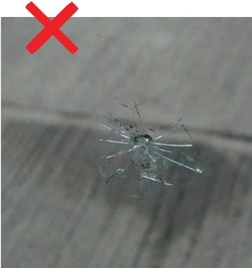
Qualquer dano no pára-brisas ou janelas (ESTALADO OU PICADO)
