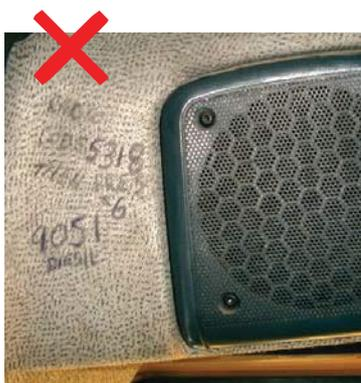
Danos permanentes causados por escrever com esferográficas ou por derrame de óleo, gordura, etc.
