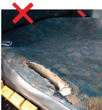
Material despedaçado, rasgado ou cortado.
