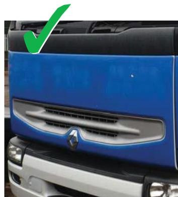
Pequena descoloração da pintura após a remoção de adesivos.
