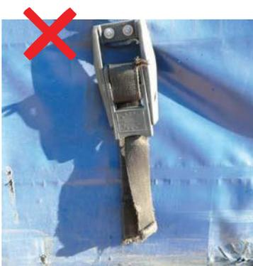
Cintas e fixadores das cortinas danificados e / ou excessivamente gastos. Desgaste devido à normal utilização das cortinas.
