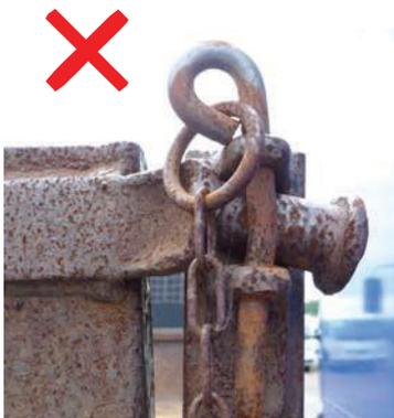
Desgaste que impeça o bom funcionamento da porta traseira ou basculamento da caixa.
