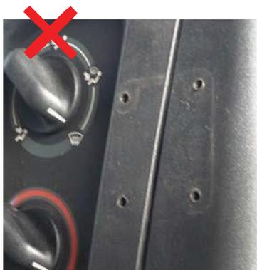
Orifícios devido à aplicação do suporte do telefone móvel, etc.
