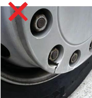
Desgaste significativo na calota ou da própria roda.
