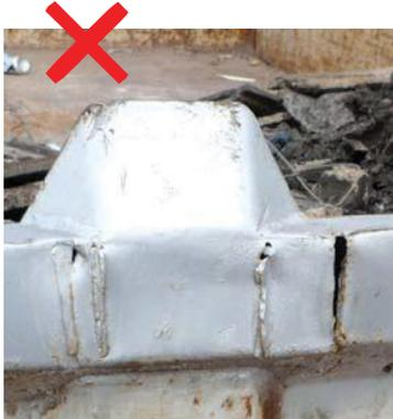
Desgaste excessivo na carroçaria e nas secções da estrutura.
