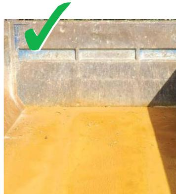
Piso de carga com desgaste normal de utilização.
