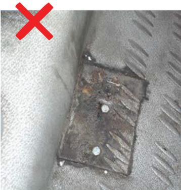
Danos permanentes causados pelo derrame de óleo, gordura e / ou desgaste excessivo no chão e / ou tapetes.
