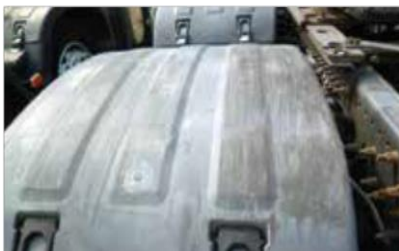
Riscos profundos, cortes ou fendas. Marcas visíveis de reparação através de remendos ou com recurso a produtos químicos ou abrasivos. Tampas das rodas em falta.
