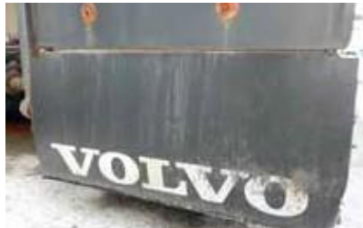
Desgaste excessivo devido à circulação fora de estrada ou nível de condução incorreto. Rasgos provocados pelo contacto com obstáculos.
